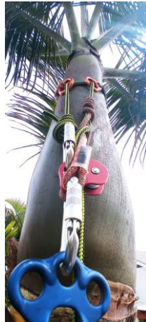
Ajuste del salvarramas al fuste y comprobación del sistema MRS.
