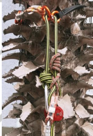
Instalación de Salvarama y Sistema de Cuerda Móvil - MRS
